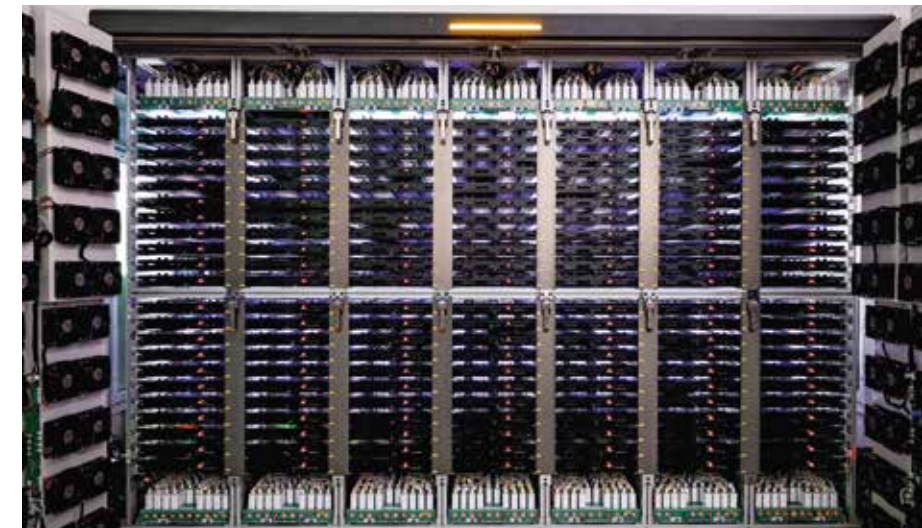
Bevor sie verpackt werden, durchlaufen die Smartphones ein stundenlanges Testprozedere, bei dem Software, Display, Funk und mehr in dieser Kammer automatisch geprüft werden.
