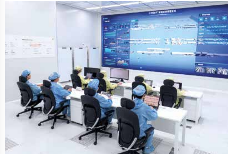
Das Herzstück der Anlage ist das Kontrollzentrum. Auf einem riesigen digitalen Dashboard laufen alle Informationen über den Fertigungsprozess der einzelnen Straßen zusammen.
