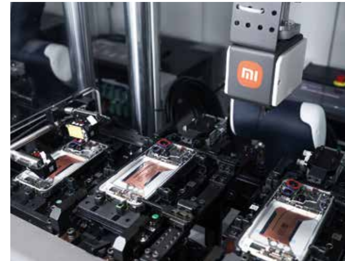
Der Automatisierungsgrad der Smartphone-Fertigung beträgt über 80 Prozent. Erst nach über 200 Einzelschritten ist ein Smartphone fertig zusammengebaut.
